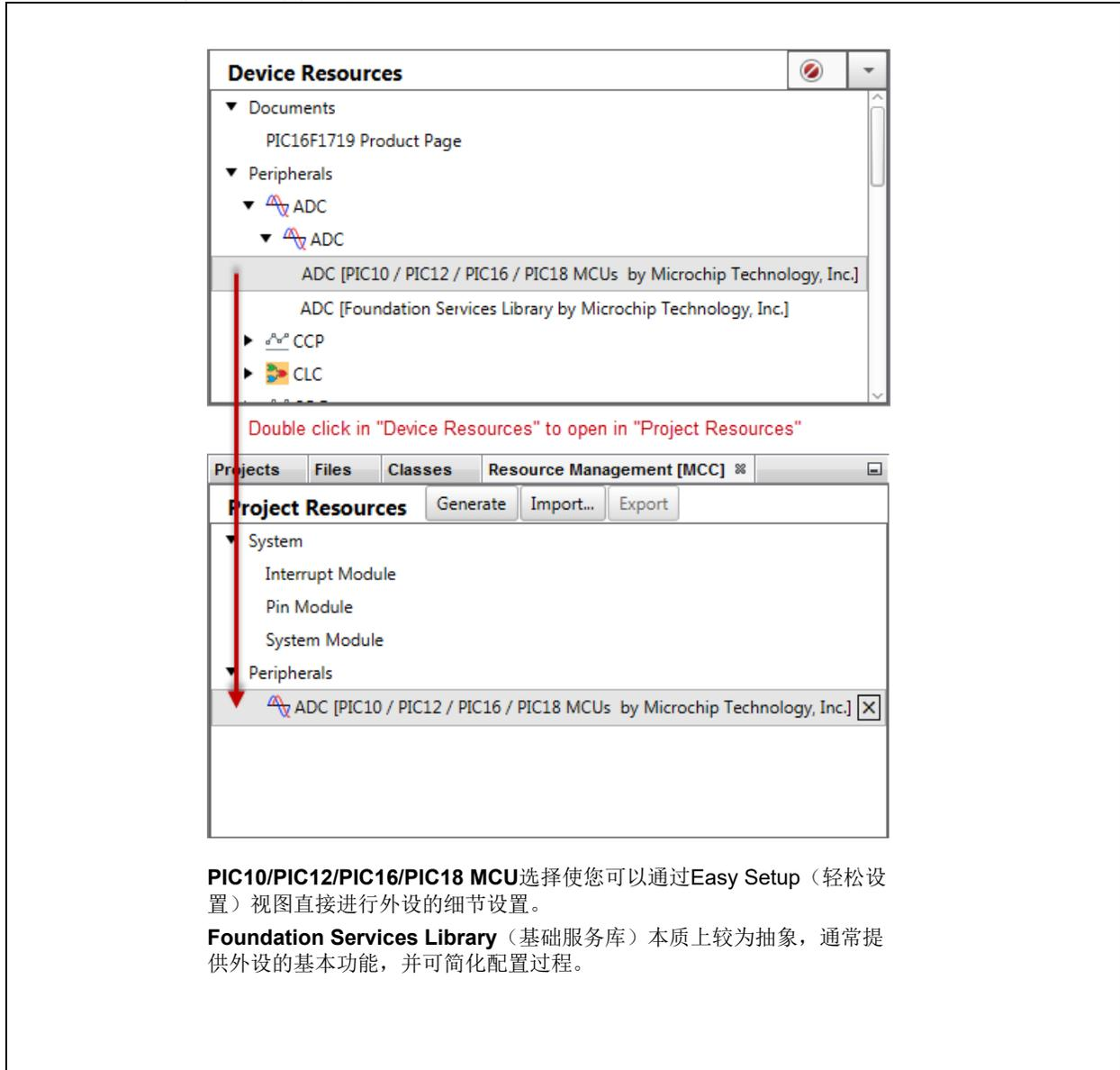
图4: ADC项目ADC资源配置
